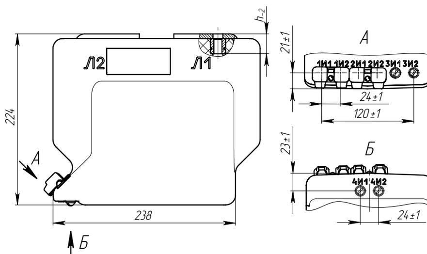
Рис. 11. Общий вид трансформатора тока ТОЛ-10-1-16
