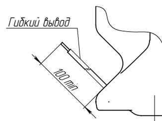
Рис. 5. Вариант с гибким выводом (ТОЛ-10-1-1В ÷ ТОЛ-10-1-17В)
