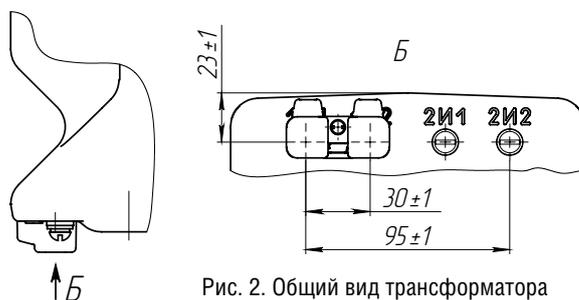
Рис. 2. Общий вид трансформатора ТОЛ-10-1-1. Остальное см. на рис. 1
