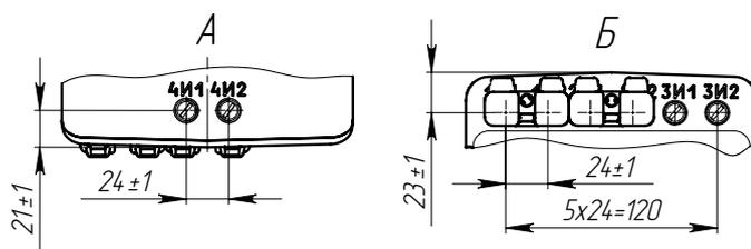
Рис. 12. Общий вид трансформатора тока ТОЛ-10-1-17
